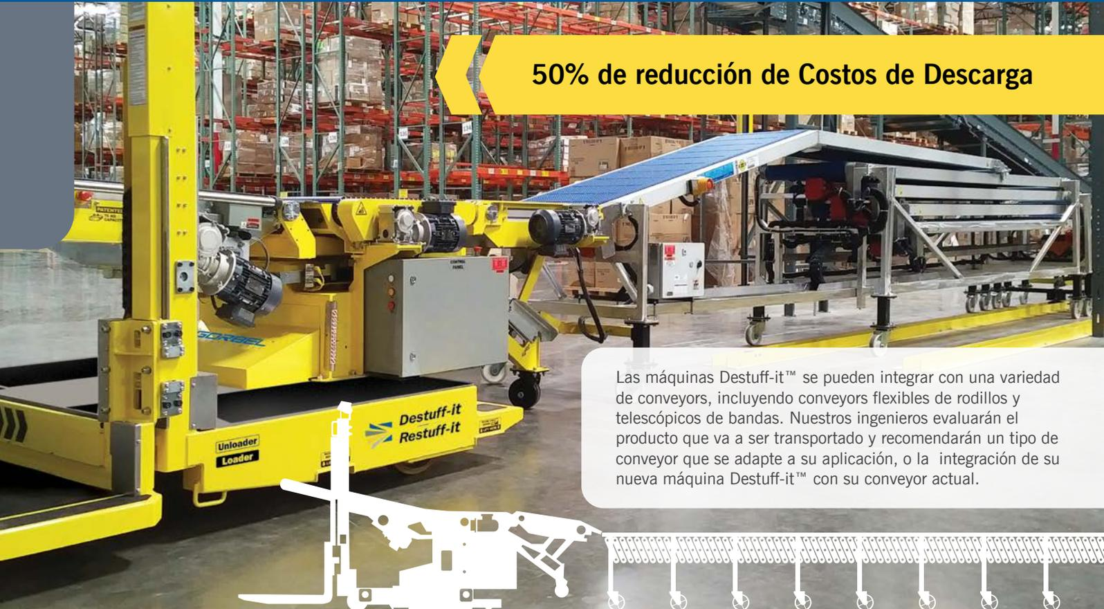
Las máquinas Destuff-it™ se pueden integrar con una variedad de conveyors, incluyendo conveyors flexibles de rodillos y telescópicos de bandas. Nuestros ingenieros evaluarán el producto que va a ser transportado y recomendarán un tipo de conveyor que se adapte a su aplicación, o la integración de su nueva máquina Destuff-it™ con su conveyor actual.
