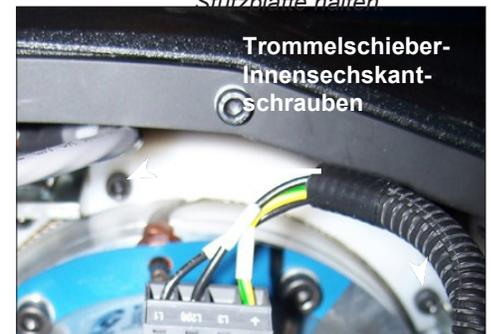
**Abb. S.** Entfernen Sie die beiden M6-Innensechskantschrauben von den Trommelschiebern.
