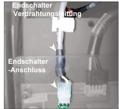
**Abb. P.** Ziehen Sie vorsichtig die graue Endschalter-Verdrahtungsleitung zum Trennen des Steckers von der Platine.
