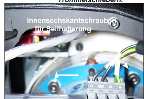
**Abb. T.** Entfernen Sie die beiden M8-Innensechskantschrauben und schieben Sie den Halter vom Seilende zu sich. Die Konfiguration kann je nach Kapazität variieren.
