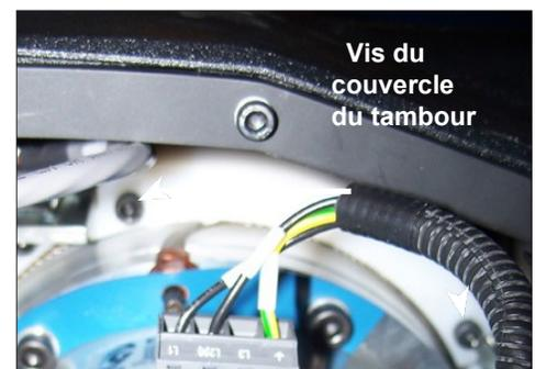
**Schéma S.** Retirez deux vis à tête creuse M6 des portes du tambour.
