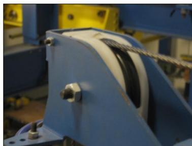
**Schéma V.** Bloc de poulie à l'extrémité du bras.
