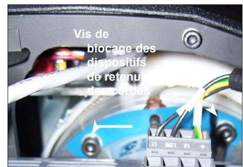
**Schéma T.** Retirez les deux vis à tête creuse M8 et faites glisser le dispositif de retenue de l'extrémité de la corde vers vous. La configuration peut varier en fonction de la capacité.
