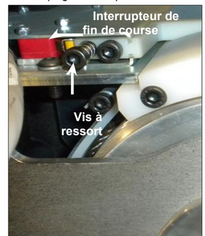
Schéma O. Repérez la tête de vis du bouchon à tête creuse et enfoncez-la complètement jusqu'à ce qu'elle ne puisse plus bouger.
