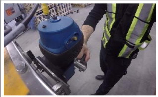
Getreidefundamente mit dem Gorbel G-Force® auf die Pulverbeschichtungsanlage geladen. Das Behälterfundament wird von einem Stapel angehoben und dann an Haken aufgehängt, die das Produkt aufhängen, während es durch die Linie läuft. Am Ende der Linie wird das Produkt aus den Haken genommen und mit dem gleichen G-Force®-Handhabungsgerät gestapelt.
