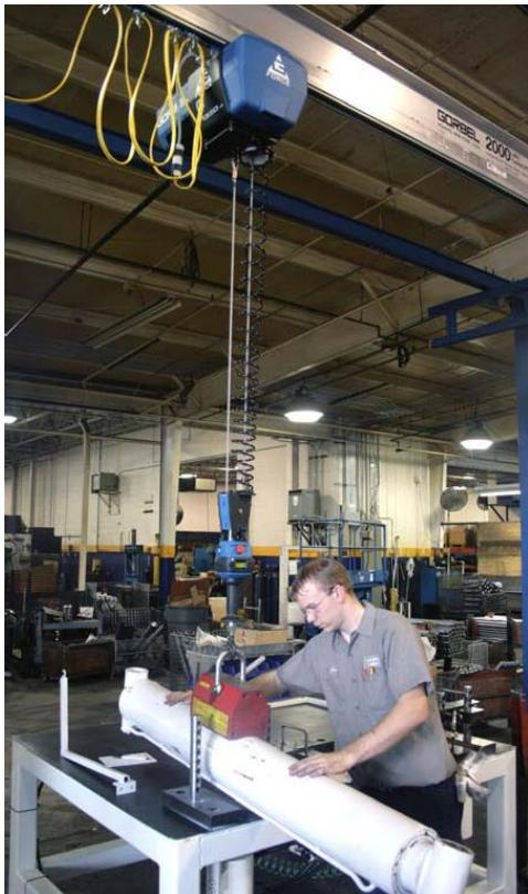
Das Unternehmen hatte mehrere Kettenzüge in der gesamten Anlage, wollte aber eine Hebevorrichtung, die dem Bediener mehr Kontrolle und Manövrierfähigkeit beim Handling der großen Zylinder bietet. Als Nomax Solutions einen G-Force® für eine Demonstration mit den Mitarbeitern des Unternehmens einführte, fanden sie heraus, dass die beste Lösung direkt in ihren Händen lag.
