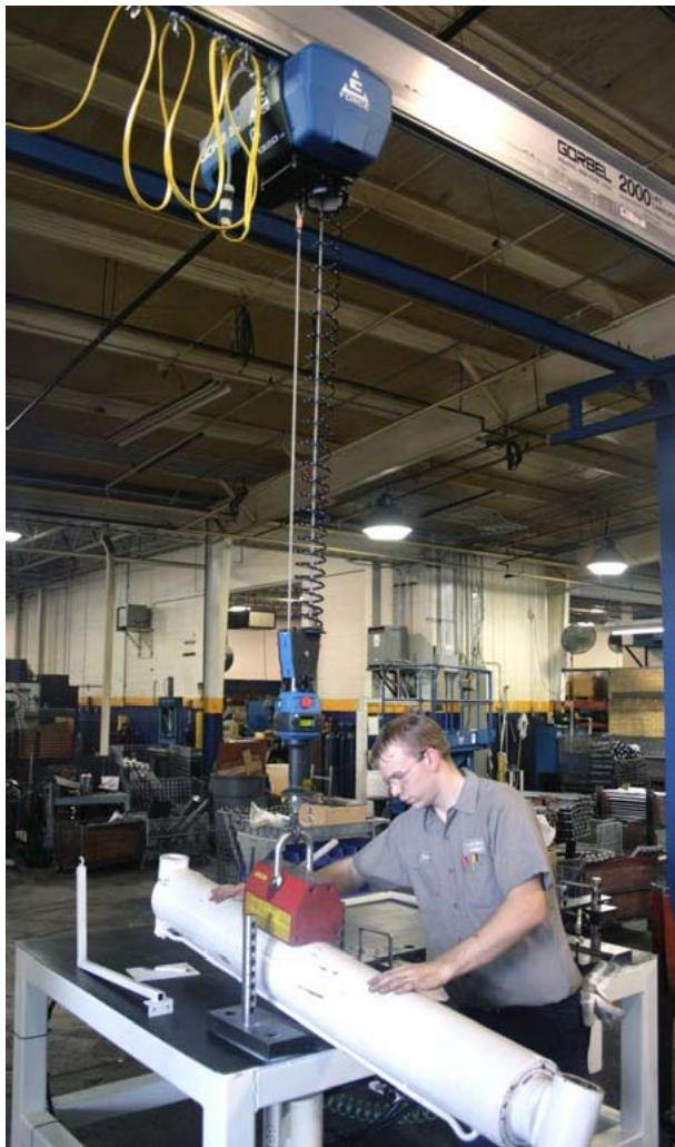
La empresa tenía varios polipastos de cadena por toda la instalación, pero quería un dispositivo de elevación que diera a los operarios más control y maniobrabilidad al manejar los grandes cilindros. Cuando Nomax Solutions trajo un G-Force® para una demostración con el personal de la empresa, descubrieron que la mejor solución estaba en sus manos.
