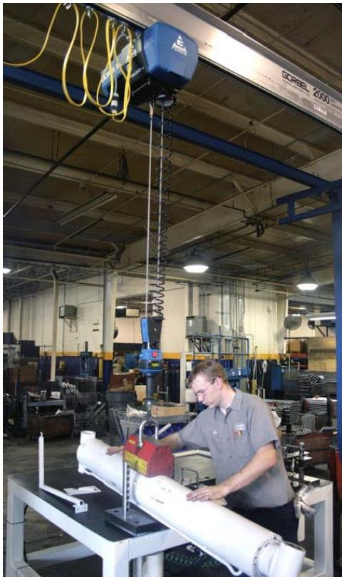
L'azienda aveva diversi paranchi a catena in tutta la struttura, ma voleva un dispositivo di sollevamento che desse agli operatori più controllo e manovrabilità durante la movimentazione dei cilindri di grandi dimensioni. Quando Nomax Solutions ha portato una G-Force® per una dimostrazione con la forza lavoro dell'azienda, ha scoperto che la soluzione migliore era nelle loro mani.
