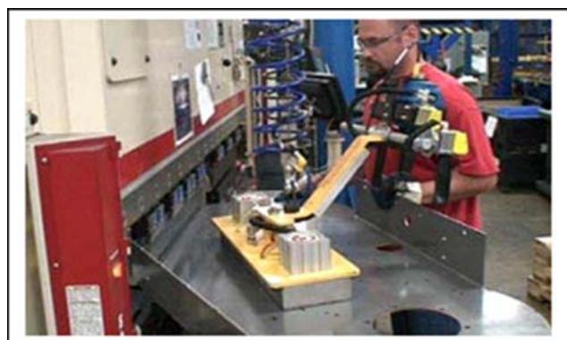
migliore era il modello Easy Arm® Q autoportante con una capacità di 150 Kg, un'estensione di 4,3 metri e un'altezza di 3 metri sotto al braccio.
